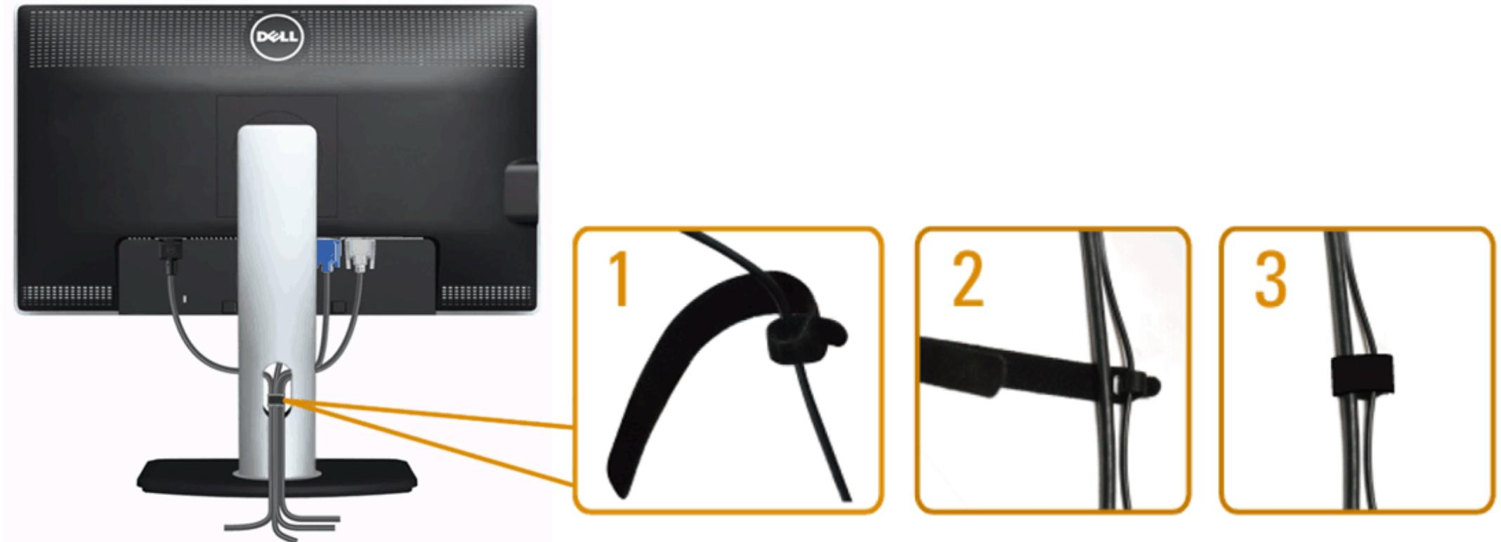
Nachdem Sie sämtliche erforderlichen Kabelverbindungen an Monitor und Computer hergestellt haben (siehe [Monitor anschließen](#)), führen Sie die Kabel wie oben gezeigt ordentlich durch den Kabelschacht.
